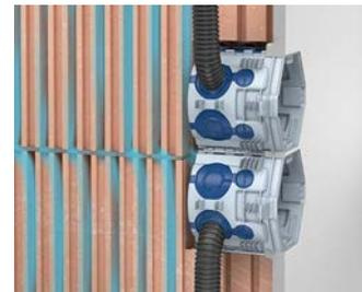
Bei Hohlkammersteinen entsteht vertikale Zugluft. Die UP<sup>1</sup> Dosen mit ECON®-Technik verhindern den Luftaustausch.
