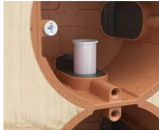
Zum vollisolierten Verbinden bei Mehrfachkombinationen wird der Verbindungsstutzen (Art.-Nr. 9060-88) in die geöffnete Leitungseinführung gesteckt.
