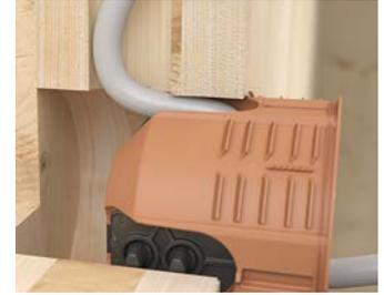
Bei der Dosenmontage drücken sich die Leitungen von außen in die Membran, damit die Dose in die Einbauöffnung geführt werden kann.
