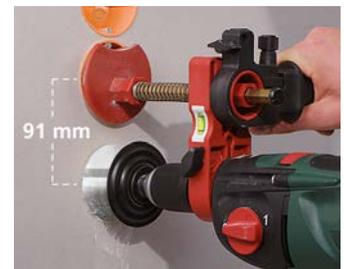
Abstand 91 mm: Zentrierteller in vorhandenes Loch oder Dose setzen, ausrichten und weitere Öffnung fräsen.
