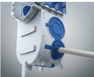
Die dauerelastische Dichtungsmembran der ECON<sup>®</sup>-Technik garantiert den luftdichten Anschluss von Leitungen bis Ø 11 mm und Rohren bis Ø 32 mm.
