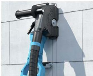
Leitungswege vorbereiten. Eine direkte Leitungsführung durch Mauerwerk und Dämmung sollte vermieden werden.
