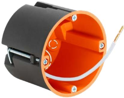
Abgeschirmte Geräte-Verbindungsdose für die Hohlwand-Installation. Die leitfähige Beschichtung als Störschutz mindert Aus- und Einstrahlung von Störquellen mit überwiegend elektrischem Wechselfeld.
