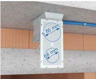
Universal Frontteil für Einbaudurchmesser 68 mm zum Einschlagen oder universell bis  $\varnothing$  86 mm zum Ausfräsen (um 180° drehen).
