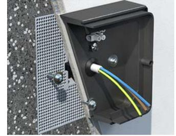
Leuchten und viele weitere Geräte werden einfach mit Schrauben bis Ø 4 mm durch den Putz an der Montageplatte befestigt.
