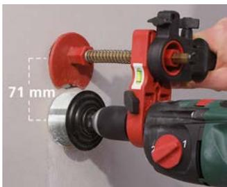
Abstand 71 mm: Erste Öffnung wie gewohnt fräsen. Zentrierteller in erste Öffnung setzen und zweite Öffnung fräsen.
