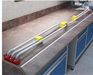
Die geplanten Baugruppen für die jeweiligen Beton-Wandelemente können werksseitig passgenau und termingerecht vorkonfektioniert...
