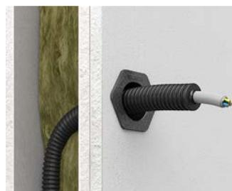
Bei Installationen in Brandschutzbereichen verschleißt der Dichtstopfen die Rohrenden und sorgt für den rauchdichten Raumabschluss.
