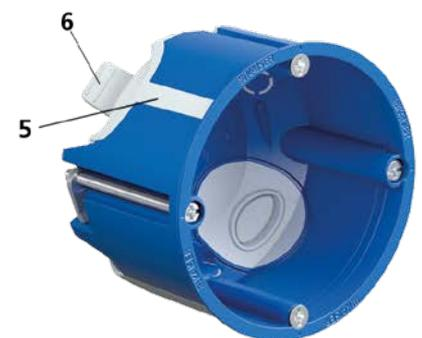
**1** Wand, ohne Einbauten, 69 dB. | **2** Schallschutzdose 9069-03, 1-fach, mit Gerät, 69 dB. | **3** Schallschutzdose 9069-04, 1-fach, mit Gerät, 69 dB. | **4** Der massive Dosenkörper und die schallabsorbierende Oberfläche am Dosenboden gewährleisten den Schallschutz bis 69 dB. | **5** Schallabsorbierende Streifen am Dosenrand zur Reduzierung des Körperschalls. | **6** Leichtgängiges Öffnen der Rohrein-führung durch vorgeprägte Öffnungslasche.
