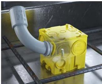
Die Spitze der Rohrkupplung 90° an der Markierung einstecken und mit Druck gegen die B<sup>2</sup> Geräte-Verbindungsdose drehen, bis die Durchführung ausgeschnitten ist.
