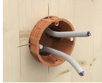
Ausrichten der Dose für eine exakte Positionierung anhand der Mittenkennzeichnungen am Halterand und an der ersten Klemmrippenreihe.
