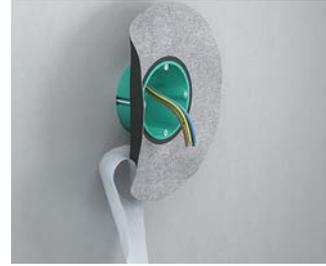
Schrittweises Entfernen der rückseitigen Abdeckfolie, Ausrichten der Dose in der Einbauöffnung und anschließendes Verstreichen der Manschette zum Verkleben auf der Wandoberfläche.
