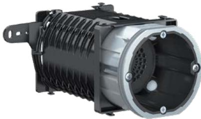
Geräte-Verbindungsdose für Elektro-Installationen in Innendämm-Systemen. Zur dauerhaft sicheren und wärmebrückenfreien Befestigung von Schaltern, Steckdosen und weiteren Geräten in innenseitig gedämmten Außenwänden. Für ein optimales Raumklima mit nachgewiesenem Schutz vor Feuchteschäden. Anwendbar in vielen Innendämm-Systemen.
