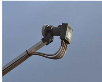
Hier werden 4 Koaxial-Leitungen für den Empfang angeschlossen.
