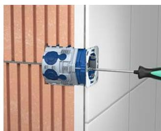
Entweder Gerät und Putzausgleich-Rahmen mit einer Schraube zusammen an der Dose montieren...
