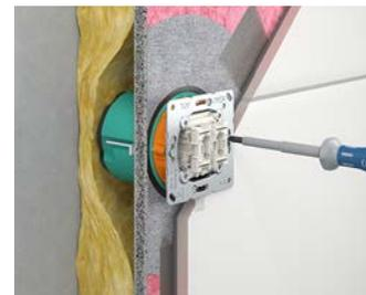
Zur Einhaltung der IP-Schutzklasse kann bei aufbauenden Wandbelägen > 10 mm der Putzausgleichsring (Art.-Nr. 9155-61 bzw. -62) montiert werden.
