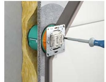
Zur Einhaltung der IP-Schutzklasse kann bei aufbauenden Wandbelägen > 10 mm der Putzausgleichsring (Art.-Nr. 9155-61 bzw. -62) montiert werden.
