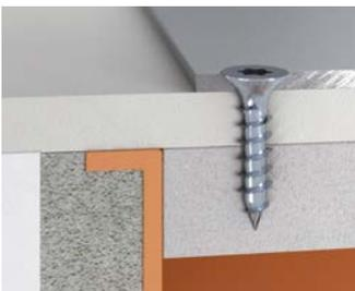
Bei der Gerätebefestigung verwenden Sie nur Schrauben, die in, aber nicht durch die Mineralfaserplatte reichen (z. B. SPAX Senkkopf 3,5 x 15 mm)!
