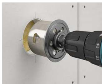
PROFI Fräser für optimale Einbauöffnungen in Trockenbauwänden und -Decken mit Verkleidungen aus Gipskarton.
