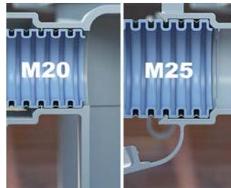
Die Kombirohreinführung bietet einen sicheren Anschluss für ummantelte sowie für nicht ummantelte Rohre und ist individuell nutzbar für die Rohrgrößen Ø 20 mm oder Ø 25 mm. Sie bietet eine hohe Auszugssicherheit und macht durch den integrierten Tiefenanschlag das nachträgliche innenseitige Kürzen der Rohre überflüssig.
