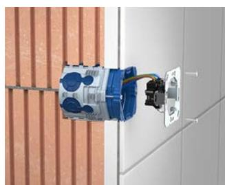
...oder erst den Putzausgleich-Rahmen montieren und später das Einbaugerät befestigen.
