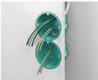
Vollisolierte Durchverdrahtung im normativen Mittenabstand von 71 mm mittels Verbindungsstutzen (Art.-Nr. 9060-78).
