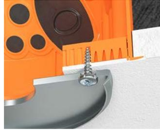
Bei der Gerätebefestigung verwenden Sie nur Schrauben, die in, aber nicht durch die Anschraubfläche reichen (z.B. Schraube mit Halb-Rundkopf 3,5 x 15 mm)!
