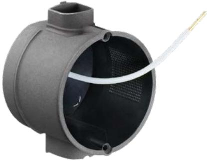
Abgeschirmte Geräte-Verbindungsdose für die Unterputz-Installation. Die leitfähige Beschichtung mindert die Aus- und Einstrahlung von Störquellen mit überwiegend elektrischem Wechselfeld.
