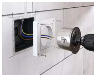
Die Installationsöffnung können Sie vor oder nach dem Einsetzen des Gehäuses herstellen. Die Gerätebefestigung erfolgt durch einfaches Hinterklemmen oder Verschrauben in der Mineralfaserplatte.
