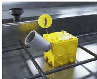
Die Spitze der Rohrübergangskupplung an der Markierung einstecken und mit Druck gegen die B<sup>2</sup> Geräte-Verbindungsbox drehen, bis die Durchführung ausgeschnitten ist.
