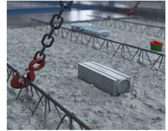
Nach dem Aushärten wird die Elementdecke ausgeschalt und für den Transport zur Baustelle vorbereitet.
