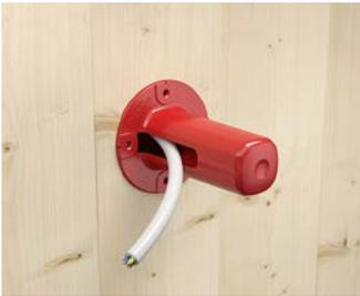
Die Dose wird mit dem Setzwerkzeug (Art.-Nr. 1090-12) einfach in die  $\varnothing$  74 mm-Einbauöffnung der Massivholzwand gedrückt.
