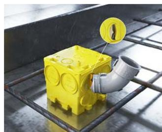
Spitze der Rohrkupplung 60° an der gewünschten Rohreinführung einstecken und drehen bis die Durchführung ausgeschnitten ist.
