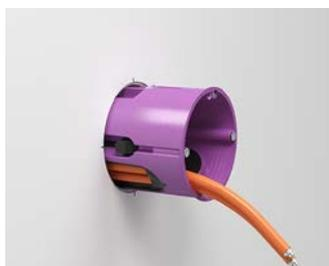
Bei der Dosenmontage die Leitungen von außen in die Membran legen, um die Dose in die Einbauöffnung führen zu können.
