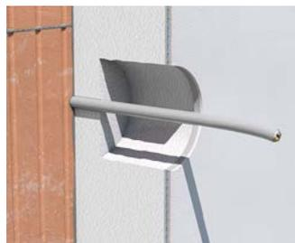
Durch den Tiefenanschlag entsteht ein minimaler Einriff in die Dämmung und somit werden Wärmebrücken vermieden.
