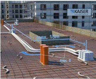
Nach DIN 18015-1 sind Zugkästen bei Rohrstrecken über 15 m Länge oder mehr als 2 Bögen erforderlich.
