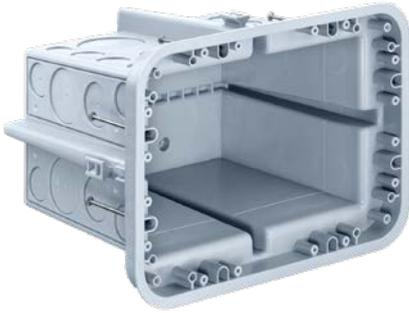
KAISER Zugkästen sichern die fachgerechte Leitungsführung durch Rohrnetzwerke. Rohrlängen von mehr als 15 m sowie mehr als zwei Bögen erfordern nach DIN 18015-1 Zugkästen, die das Nachziehen oder Nachbelegen von Leitungen jederzeit ermöglichen. Zugkästen bieten vielfältige Rohreinführungsmöglichkeiten und maximalen Raum zur Sicherung eines durchgehenden Leitungsnetzes – auch bei nachträglichen Veränderungen der Elektro-Installation.
