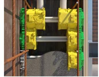
Der integrierte Federweg im Rückteil der B<sup>1</sup> Gerätedose gleicht Bautoleranzen, wie z. B. das Atmen der Schalungen während des Betoniervorgangs aus und hält die B<sup>1</sup> Gerätedose sicher in Position.
