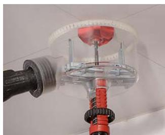
VARIOCUT mit Zentrierbohrer aufsetzen. Anbohren, das Schutzgehäuse plan aufsetzen und mit leichtem Druck Öffnung schneiden.
