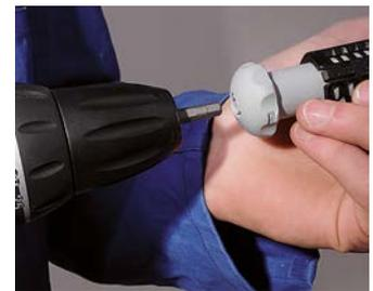
TIPP: Um mehrere Öffnungen zu schneiden oder harten Kunststoff zu bearbeiten, können Sie den Öffnungsschneider auf den 1/4"-Bit eines Akkuschaubers aufsetzen.
