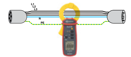
Anschlussbild 1235/1236 Anwendungsbeispiel für eine Differenzstrommessung unter Netzspannung (Leckstrom) z.B. mit AC50A, CHB5 oder CHB1
